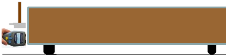
Figura 1: Sistemática en la medición de la frecuencia de resonancia mediante al aparato MTG (Brookhuis).
