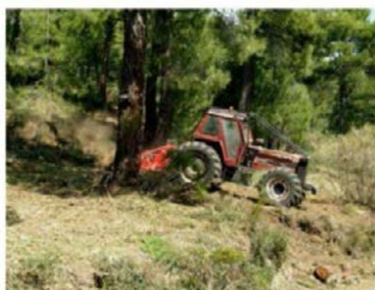
Desbrozadora de eje horizontal acoplada a tractor de ruedas. Abantos, marzo de 2005. Foto Planelles.
