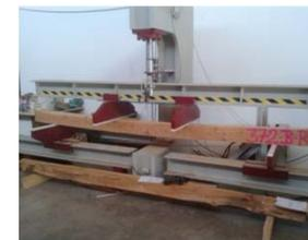
7. Ensayos mecánicos a rotura
